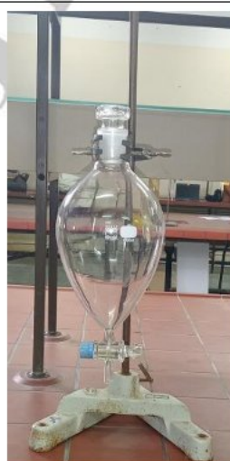
Figure IV.1 : Schéma du dispositif employé pour une extraction Liquide-liquide ou un lavage.
