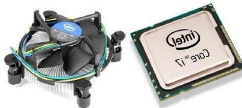
**Figure 2 : Le processeur et son système de refroidissement**
