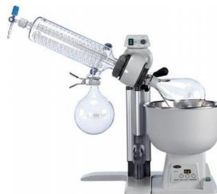
Intérêt de la rotation : La rotation du ballon plaque le liquide sur les parois ce qui a pour effet d'augmenter la surface de contact avec la source thermique et ainsi d'homogénéiser le chauffage.
