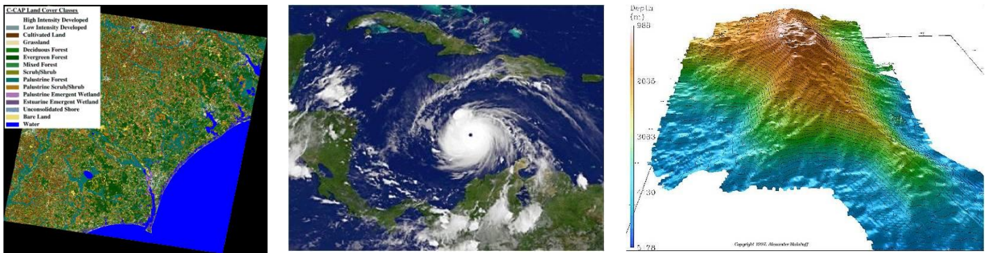
Figure 3 : Quelques exemples d'application de la télédétection spatiale : carte d'occupation du sol, suivi des conditions atmosphériques, réalisation de modèles numériques de terrain (MNT)
