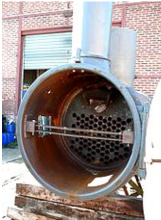
Figure 4.10 : Chaudière tubulaire neuve destinée à la locomotive
