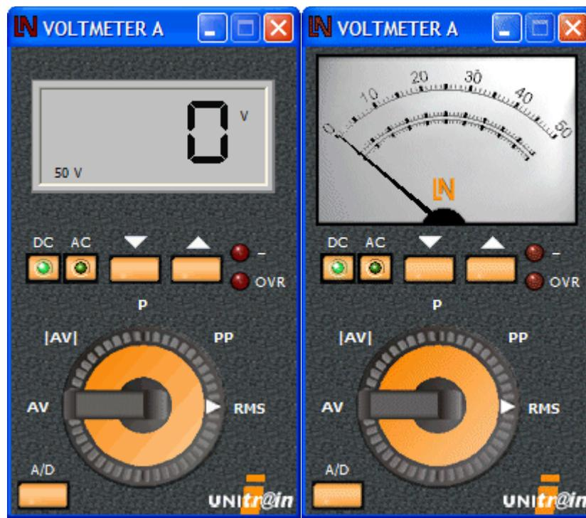
**Figure2. Instrument virtuel Voltmètre (à gauche : affichage numérique, à droite : affichage analogique)**
