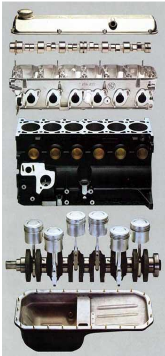
Fig.1.2 : Vue éclatée d'un moteur à explosion.
