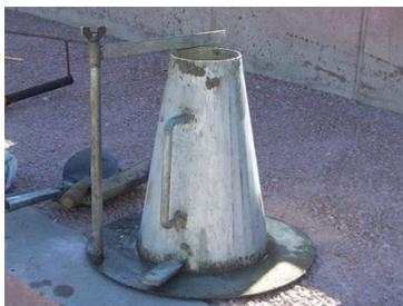
**Figure 16 :** Essai d'affaissement au cône d'Abrams.
