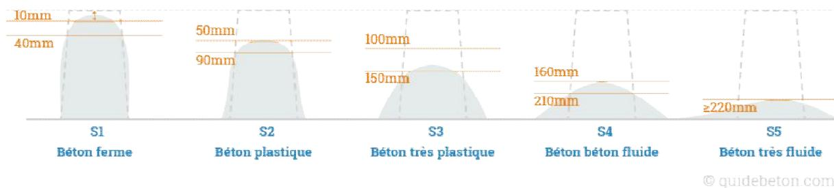
**Figure 17 :** Classes de consistance des bétons.
