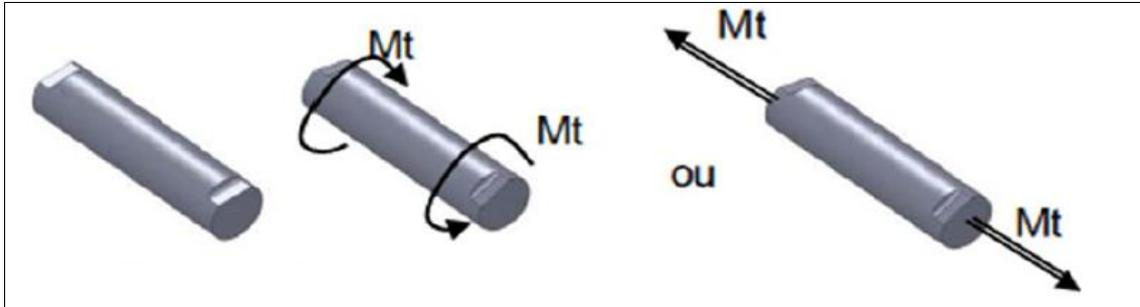
Figure 4.1. Moments des actions extérieures appliqués à la poutre
