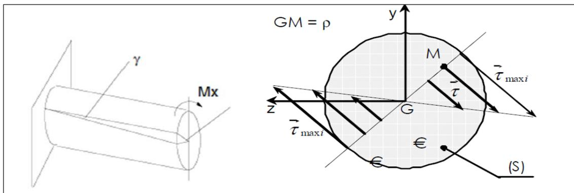
Figure 4.4 : Répartition des contraintes au niveau de la section.
