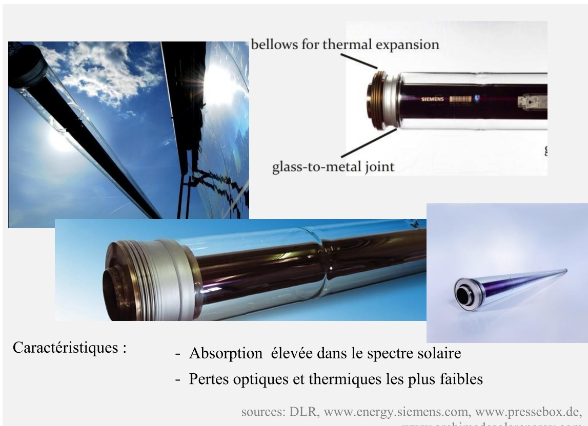
Fig.2.18. Composition du récepteur
