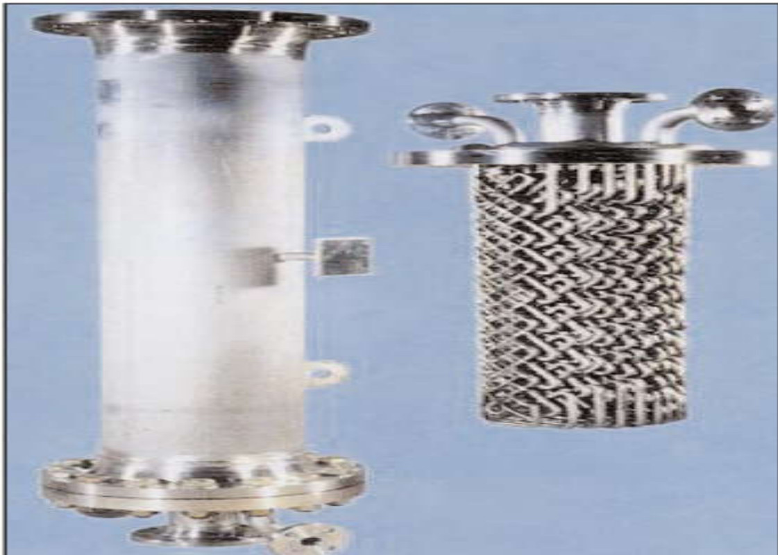
Figure 2. Le réacteur-mélangeur est un exemple classique d'équipements d'intensification de procédés
